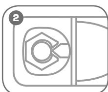
**Создайте давление помпой, разрежьте гайку**
