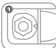
**Установите гайку в рабочую область гайкомола**
