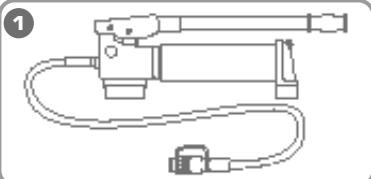
**Установите инструмент по возможности на ровной, плоской поверхности. Такое положение обеспечит устойчивость насоса во время работы**
