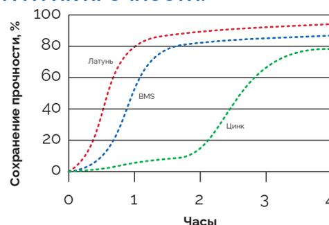
Клей, нанесенный на медь и ее сплавы, затвердевает быстрее, чем клей, контактирующий с окисленными или пассивными поверхностями, в том числе нержавеющей сталью. Набор прочности происходит быстрее при нагреве (до 80 °C) или в узком зазоре. Для ускорения полимеризации можно использовать активатор.
