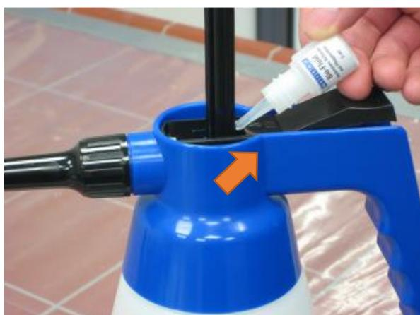
2. Поднять поршень на всю длину. Нанести WEICON Bio-Fluid на указанное на изображении место. Распределить смазку равномерно, путем многократного поднятия поршня.
