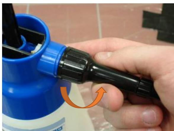
3. Если применяется WEICON Cleaner S, Brake Cleaner, Rust Loosener, Surface Cleaner или Electro Contact Cleaner, то необходимо после первого использования повернуть распыляющую насадку на пол оборота, так как находящая внутри прокладка изменяется в объеме и ей необходимо больше места. После этого можно применять помповый распылитель неограниченно.
