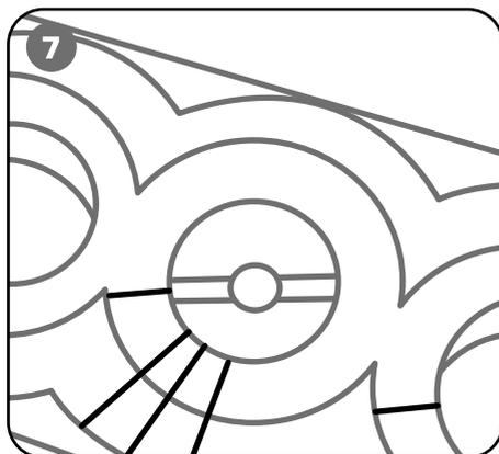
Поверните упорные валики так, чтобы метки на них были в положении «0» на угловой шкале для гибки на ребро.
