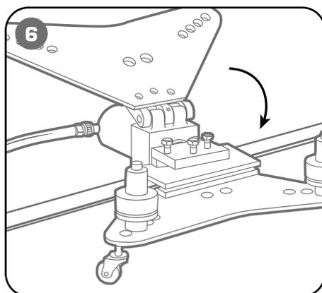
Следите, чтобы концы упорных валиков попали в соответствующие отверстия. Закройте верхнюю плиту.
