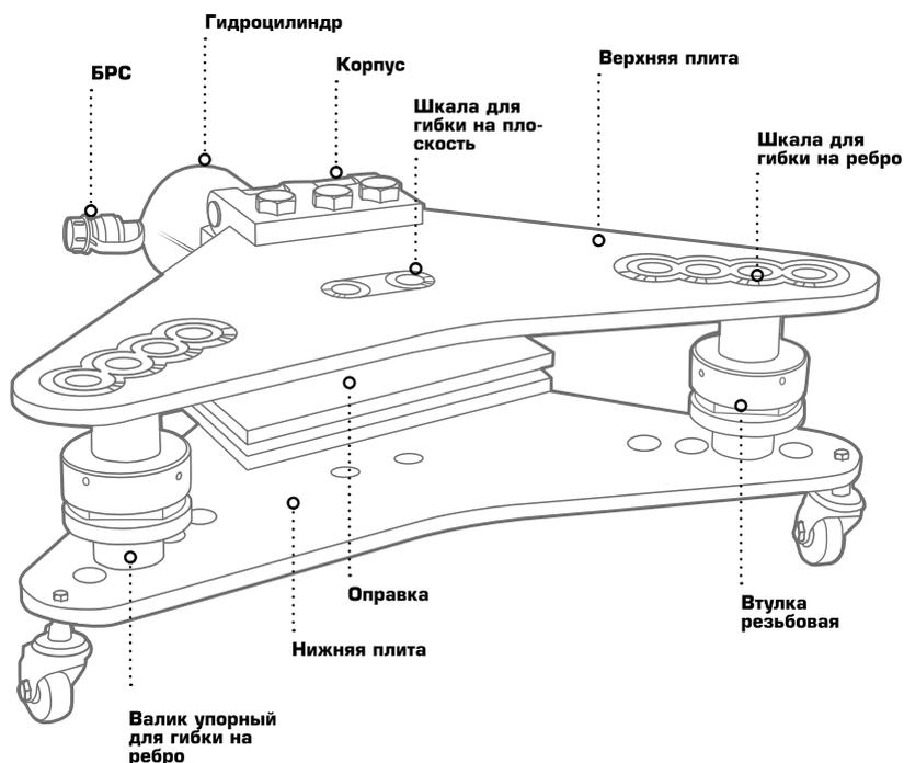
Инструмент состоит из нижней опорной плиты, на которой размещён корпус гидроцилиндра. Нижняя опорная плита имеет колёса для перемещения инструмента.
