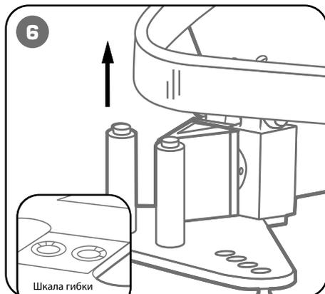
**Работая помпой, согните шину под нужным углом. Контролируйте угол по шкале для гибки на плоскость. По окончании сбросьте давление. Откройте верхнюю плиту и извлеките готовую шину.**
