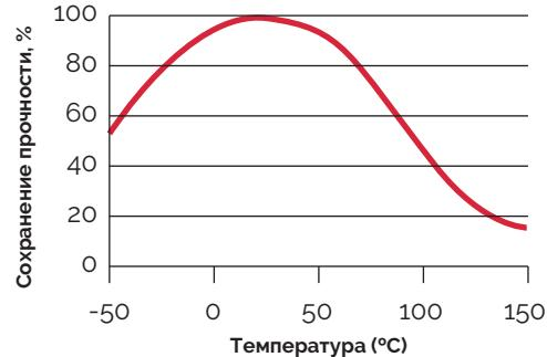
Исследование прочности на сдвиг проводится на образцах из мягкой стали. Клей наносят при комнатной температуре, соединения отверждают в нормальных условиях на протяжении 24 часов.
